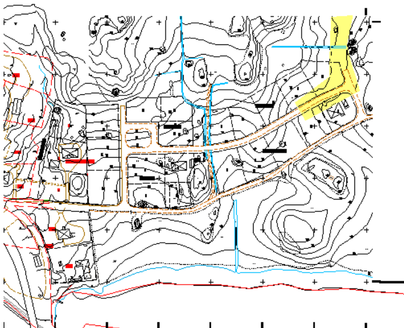
Bild 5:2 Gulmarkerat område där lös lera påträffats vid geoteknisk undersökning för gata och VA.
